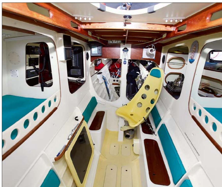
Un petit bijou l'intérieur. Depuis le siège central pivotant, Charlie peut travailler à la table à cartes côté bâbord ou en face, à la cuisine. Au premier plan, la table repas est dépliée.
